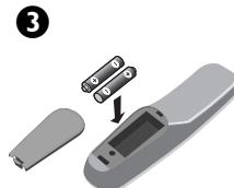
Вставьте в пульт дистанционного управления 2 батарейки типа R6, которые поставляются вместе с телевизором. Батарейки должны были установлены с правильной полярностью.
