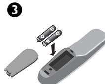
Vložte 2 baterie typu R6, které jsou přiloženy, a respektujte přitom jejich polaritu.
