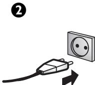
Tilslut netstikket til en stikkontakt (220-240 V / 50 Hz)
