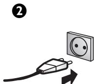
Koble strømledningen til en stikkontakt (220-240 V/50 Hz)
