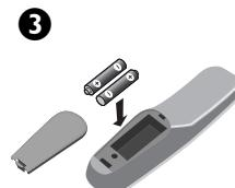
Inserire le due pile di tipo R6 (fornite) facendo attenzione alla polarità.
