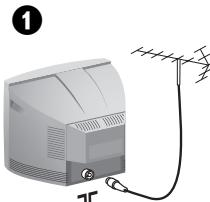
Stop de stekker van de tv-antenne in de **T**-aansluitbus aan de achterkant van het toestel.
