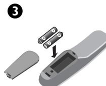
Sett inn de to R6-batteriene på riktig måte (overhold polariteten).
