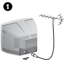
Csatlakoztassa a TV antennadugóját a készülék háttoldalán található csatlakozóba.
