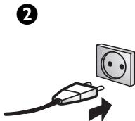
2 Podłącz wtyczkę kabla zasilającego do gniazdku (220-240 V /50 Hz).
