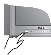
Tryk på tænd/sluk-knappen for at tænde TV-apparatet. Hvis apparatet bliver ved med at stå på standby: tryk på knappen på fjernbetjeningen.
