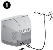
1 Podłącz wtyczkę antenową do gniazda **ANT** z tyłu odbiornika.
