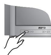
Zapnite televízor stlačením tlačidla pre zapínanie a vypínanie televízora. Ak je televízor v pohotovostnom režime, stlačte tlačidlo **P** (+) na diaľkovom ovládači.
