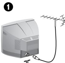
Sett antennestøpelet inn i kontakten
