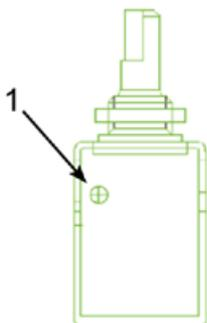
**Vis n°1** : Tournez dans le sens des aiguilles d'une montre
