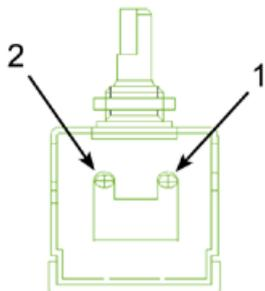
**Vis n°1 (butée)** : Tournez dans le sens contraire des aiguilles d'une montre
