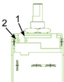
**Vis n°1 (butée)** : Tournez dans le sens des aiguilles d'une montre
