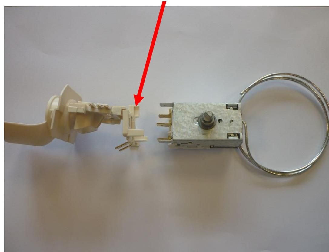
Plier de 90 degrés le côté arrière de la douille pour qu'elle s'adapte aux connexions par fiches du thermostat!
