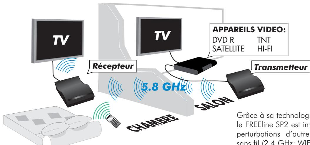
Grâce à sa technologie 5,8 GHz, le FREEline SP2 est immunisé aux perturbations d'autres appareils sans fil (2,4 GHz; WIFI).
