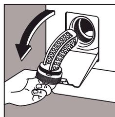
Dévissez le bouchon à fond et enlevez-le. Nettoyez-le soigneusement à l'eau courante. Remplacez l'ensemble et revissez-le dans le sens des aiguilles d'une montre.
