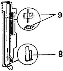
Ce changement d'épaisseur entraîne un léger jeu que l'on compense par l'adjonction de deux tampons amortisseurs 9 fixés dans les trous de pilotage supérieurs des montants d'articulations droit et gauche et par la fixation de deux clips 8 sur le bord intérieur de l'enjoliveur de porte. Voir dessin ci-contre.
