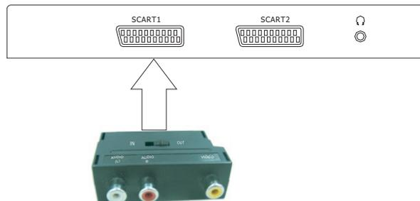
2. Le téléviseur de 26" n'a pas d'input AV, si vous voulez utiliser l'input AV, il y a un terminal SCART-AV pour vous, vous devriez insérer ce terminal à l'interface SCART du téléviseur, quand vous attachez solidement l'interrupteur du terminal à IN, vous pouvez utiliser le terminal comme input AV, ou autrement, vous pouvez utiliser le terminal comme output AV.
