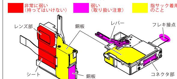
プロジェクターを使用した後は、プロジェクターユニットが熱くなっています。特に銅板の部分は高温になります。部品を交換する時は、温度が下がってから作業を行なってください。
