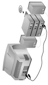
Pour le raccordement à une chaîne Hi-fi, utilisez un cordon de liaison audio et connectez les sorties "L" et "R" du téléviseur à une entrée "AUDIO IN" "L" et "R" de la chaîne Hi-fi.
