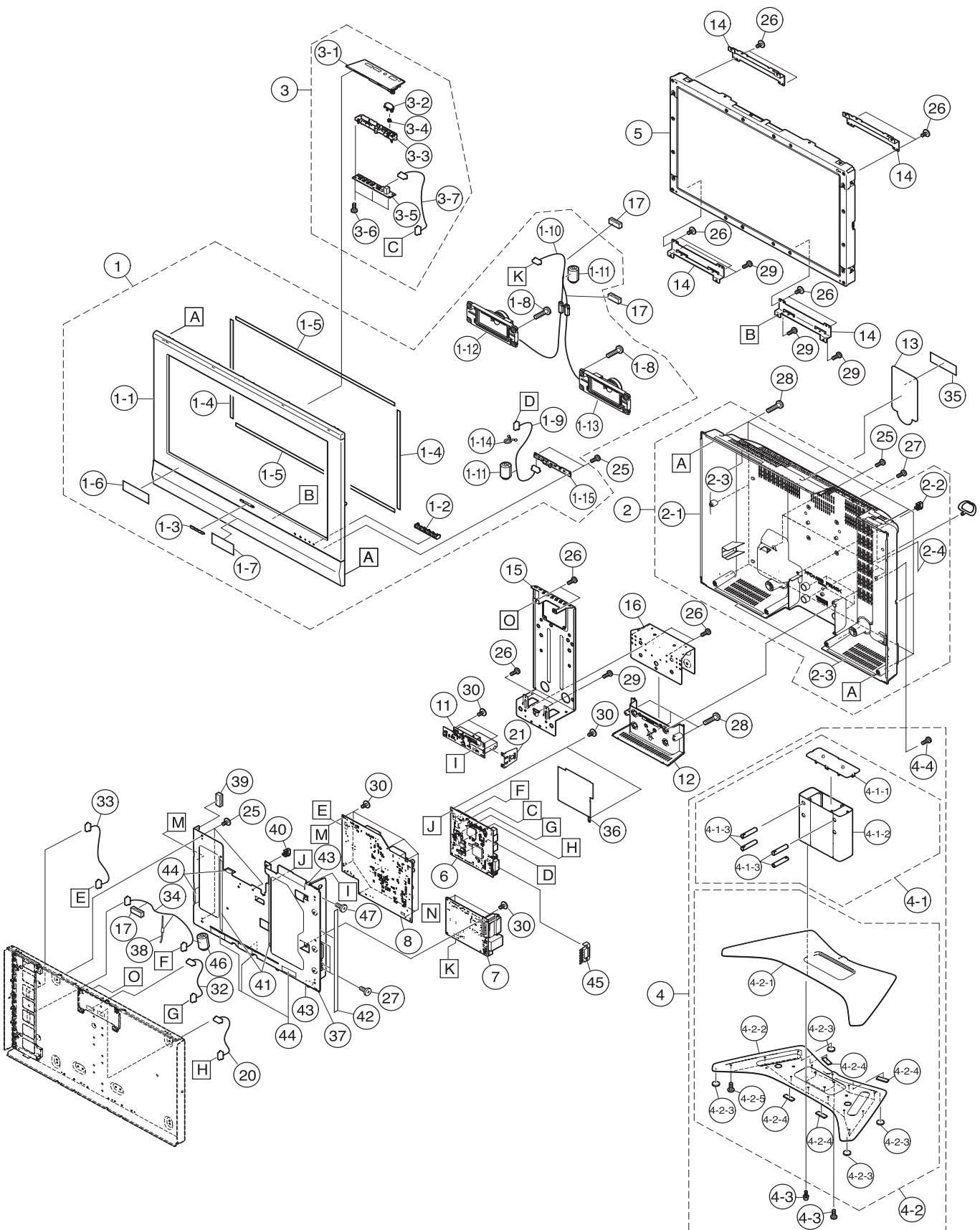
**LC-26P55E****LC-32P55E****LC-37P55E****CABINET AND MECHANICAL PARTS LISTING****(LC-32P55E/K/F/I/R)**
