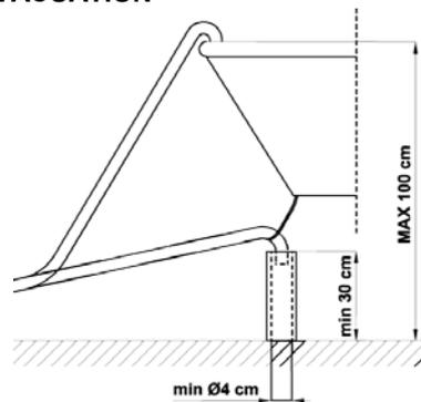
L'extrémité libre sera placée à une hauteur comprise entre **30 et 100 cm** et ne devra jamais être recouverte par l'eau. En présence de tuyaux de rallonge disposés horizontalement, pour un maximum de 3 m, placer le tuyau d'évacuation à une hauteur maximale de **85 cm** du sol.
