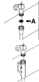
**Dans les modèles dotés d'ACQUASTOP le filtre est déjà présent dans la bague fileté.**
