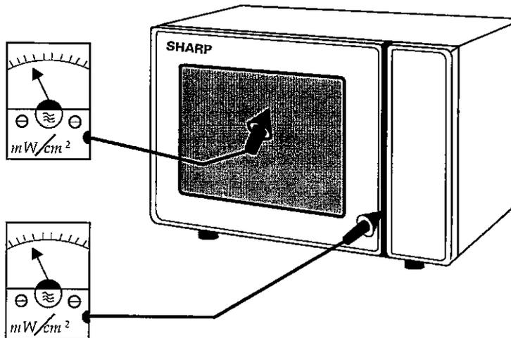
Messung der Mikrowellen-Leckstrahlung im Abstand von 5 cm
