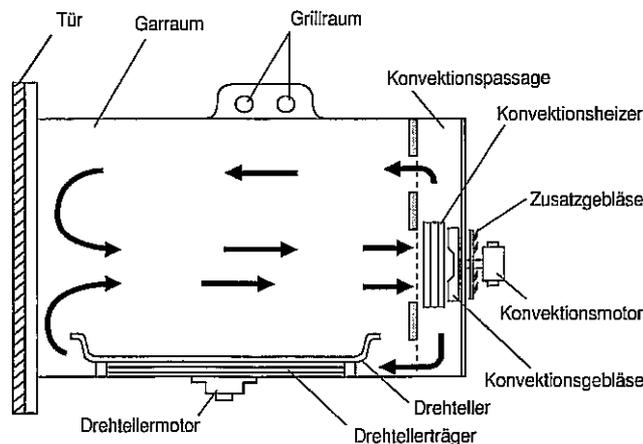
Abbildung D-2. Konvektions-Garsystem
