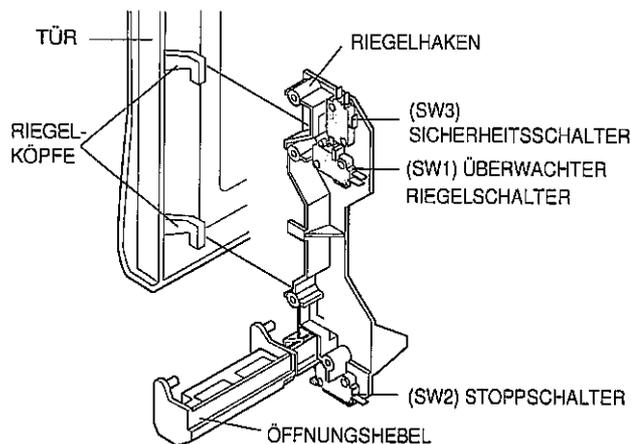
Abbildung C-6. Riegelschalter einstellen
