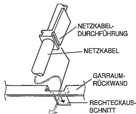
Abbildung C-4 (b). Austausch des Netzkabels
