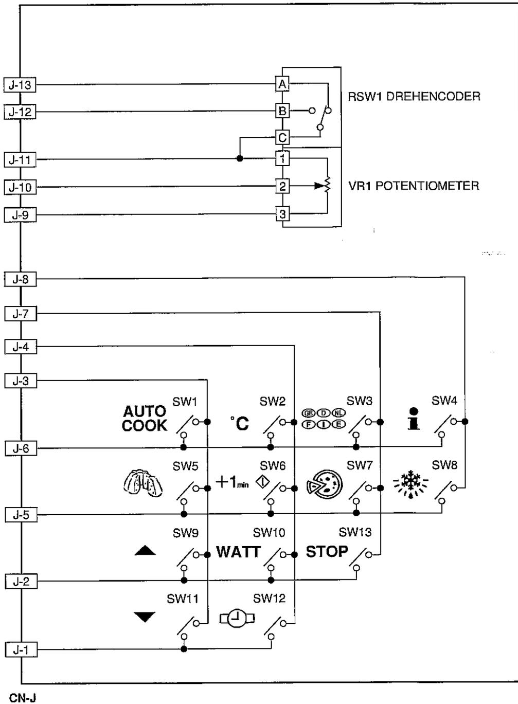
Abbildung S-3. Gedruckte Schaltung für Tasten- und Jog-Einheit
