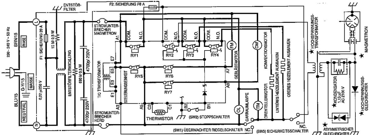
Abbildung O-4 Schaltplan Konvektionsbetrieb
