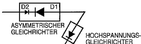
Die nominale Spitzensperrspannung von D1 (asymmetrischer Gleichrichter) beträgt 6 KV. Die nominale Spitzensperrspannung von D2 (asymmetrischer Gleichrichter) beträgt 1,7 KV. D1 und D2 des asymmetrischen Gleichrichters (Hochspannungsgleichrichter) werden kurzgeschlossen, wenn die jeweilige Spitzensperrspannung überschritten wird. (Durchbrennen der Sicherung F2 F8A).
