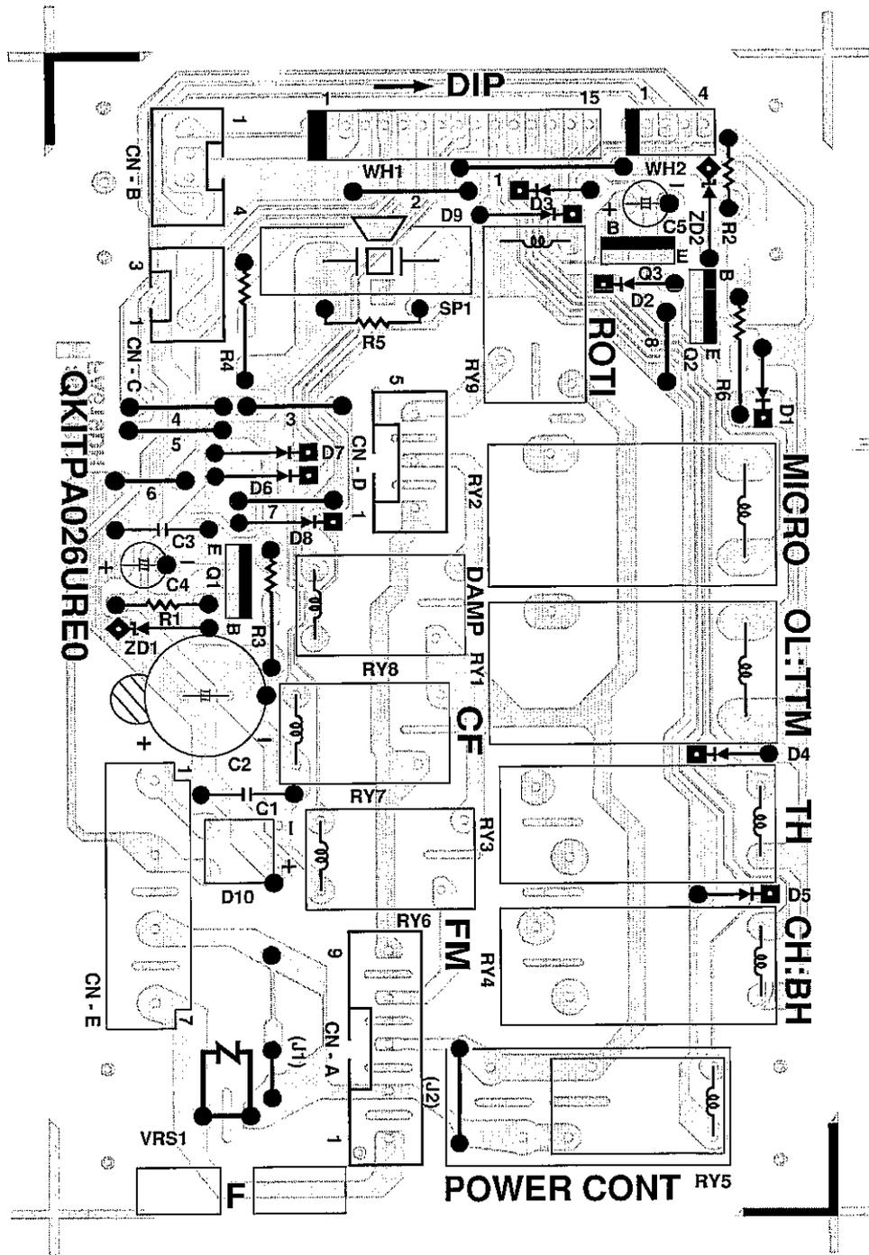
Abbildung S-5. Gedruckte Schaltung der Leistungseinheit
